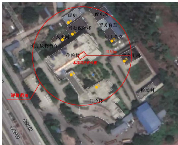
图8-3 本项目距拟建DSA检查室边界50m范围内现状监测布点示意图
